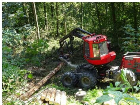
図 36 フォワーダによる集材作業
