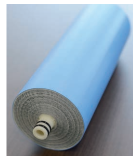
図3 パイロット試験に用いたCNT/PA複合RO膜モジュール(直径4インチ)
