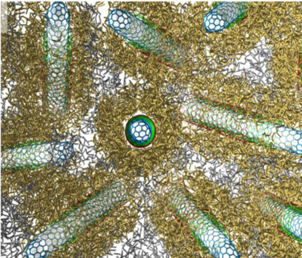
CNT（フィラー）とポリアミド（マトリックス）のナノ複合膜の構造モデル(茶色部分がポリアミドで、青～緑の亀甲が多くある構造物がCNT)。CNTの周辺に形成される固有のポリアミドのナノ構造が、この逆浸透膜（RO膜）の高い透水性と脱塩性に寄与し、フィラー（添加剤）のCNTによって耐汚染性（ファウリング特性）も向上すると考えられる。
